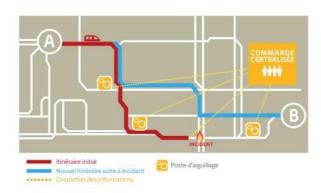
Le projet vise à rassembler la commande de 1500 principaux postes d'aiguillages et la régulation des circulations dans seize centres régionaux.
